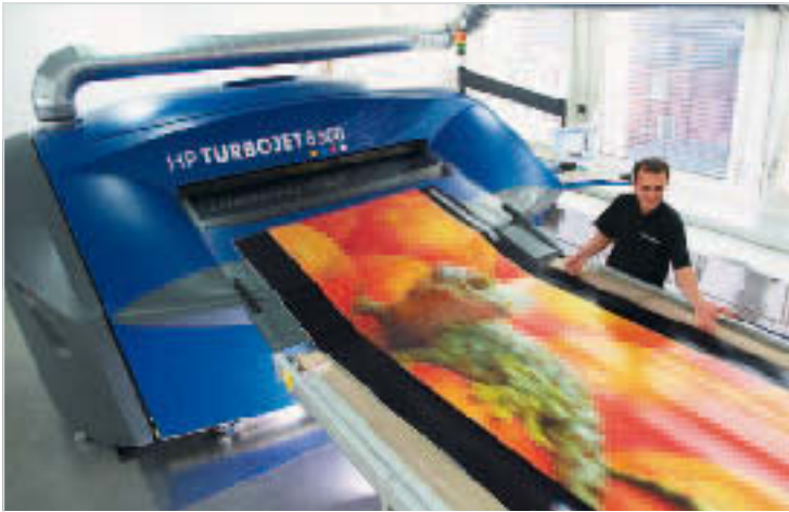
Mit dem Druckformat des HP Turbojet von 160 x 360 cm können erstmals F12-Plakate auf einem Bogen gedruckt werden.
