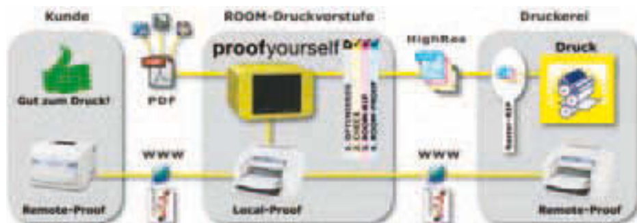
Auf dem zentralen ProofYourself-RIP gerechnete Dateien stehen als Composite-File und separiert für die ortsunabhängige Proof-Ausgabe und die Plattenbelichtung bereit.
